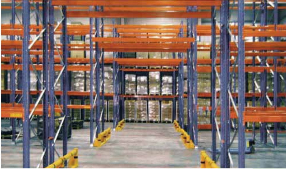
Doppelseitiges Palettenregal mit massivem Rohrrammschutz für Doppelregale
