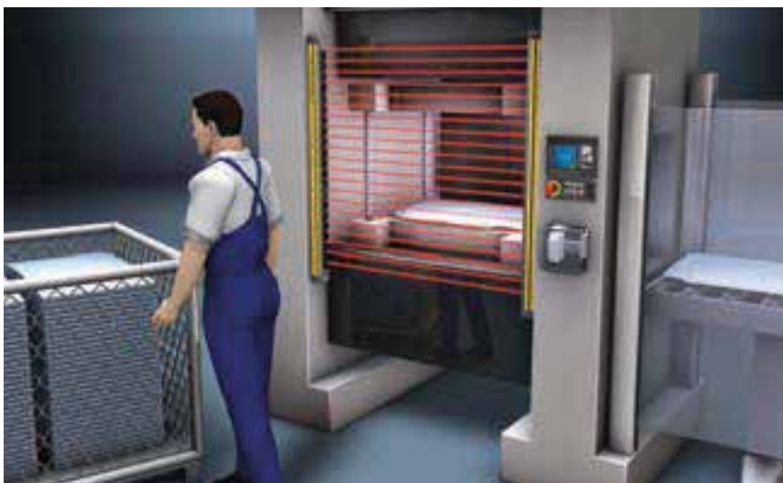
Bei Pressen spielen die COMPACT Sicherheits-Lichtvorhänge ihre Vorteile voll aus
