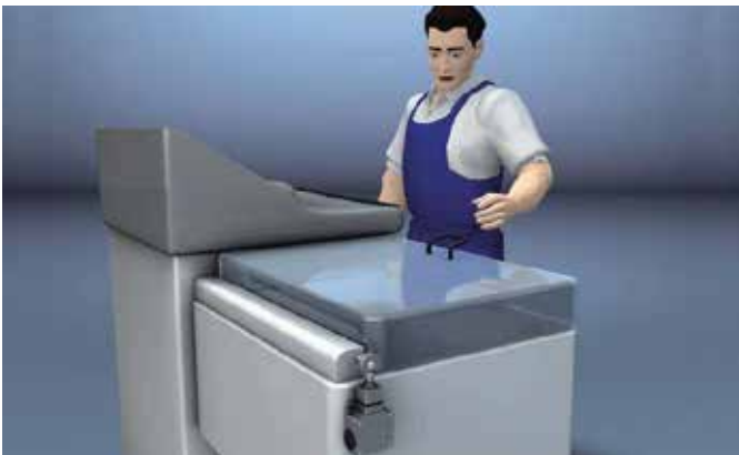
Sicherheits-Positionsschalter an Maschine mit einer Schutzeinrichtung und Drehgelenken – eine typische Anwendung z. B. in der automatisierten Teilebearbeitung
