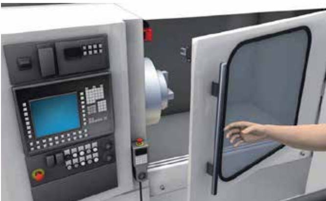
Sicherheits-Zuhaltung an einem Metallbearbeitungszentrum mit Nachlaufzeiten
