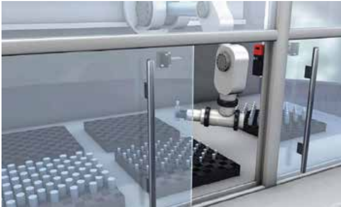
Sicherheits-Schalter S20 zur Absicherung der Schiebetür an einer Pick-and-Place-Maschine
