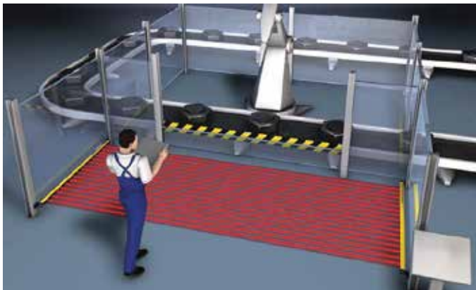
Sicherheits-Lichtvorhang mit einem Sicherheits-Relais MSI-SR4 als Gefahrenbereichssicherung mit Anlauf-/Wiederanlaufsperrung an einer Roboterzelle
