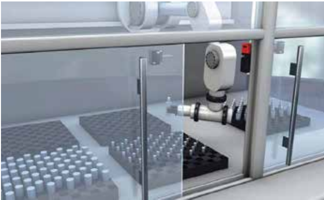
Sicherheits-Schalter zur Absicherung der Schiebetür an einer Pick-and-Place-Maschine
