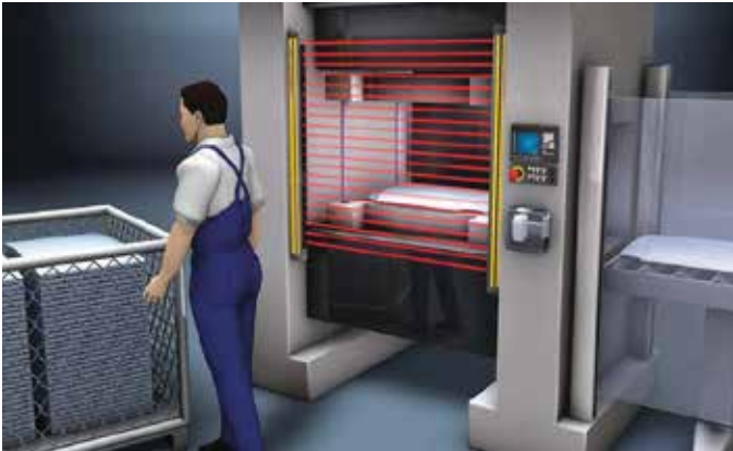
Eintakt-Steuerung einer Exzenterpresse mit einem COMPACT Sicherheits-Lichtvorhang und dem Sicherheits-Interface MSI-i/R
