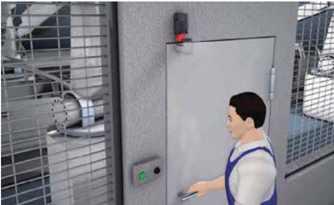
Sicherheits-Zuhaltung als Zugangssicherung
