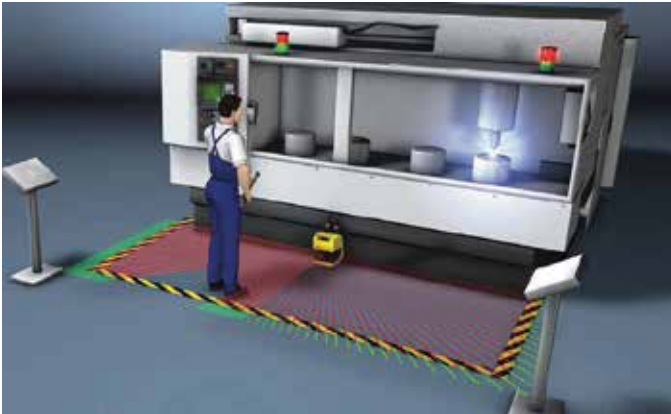
Gefahrbereichssicherung an stationären Maschinen: Umschaltung von prozessabhängigen Schutz-/Warnfeld-Kombinationen für den reibungslosen Ablauf der Fertigung
