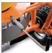
Schieber zur Streumengenregelung
