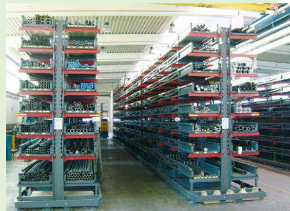
Kragarmregalanlage mit Langgutkassetten
