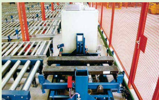
Quertransportwagen (QTW) mit neigbarer Teleskopgabel
