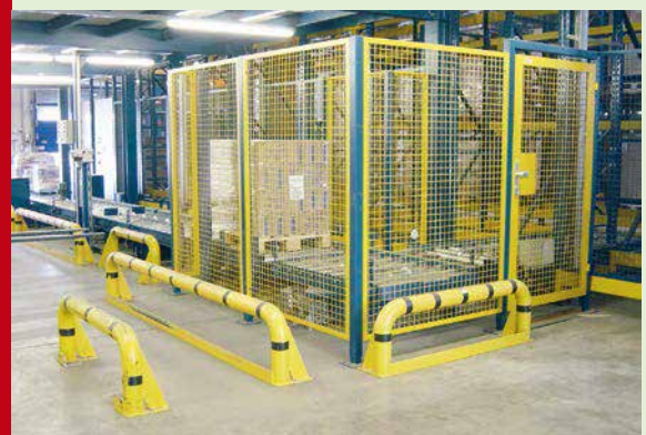
... mit Flügeltüren und Rammschutz
