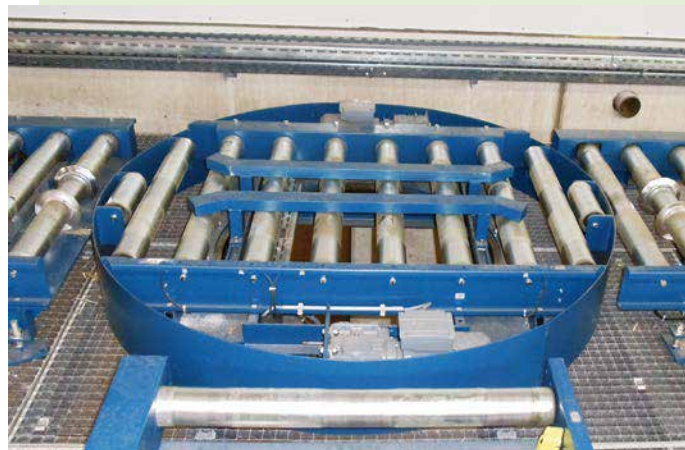
Palettendrehstation mit Palettenförderer
